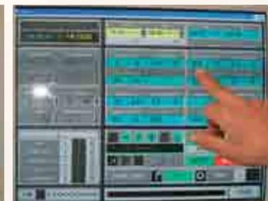
Über 80 Prozent der Schneeanlage kann vom Computer der Beschneiungszentrale auf Kreuzboden gesteuert und überwacht werden. Insgesamt verfügen die Bergbahnen Hohnsaas AG über 59 Schneeerzeuger. Diese teilen sich auf 40 vollautomatische Propellermaschinen, 9 Lanzen, 9 handbetriebene Propellermaschinen und eine Testmaschine auf.
