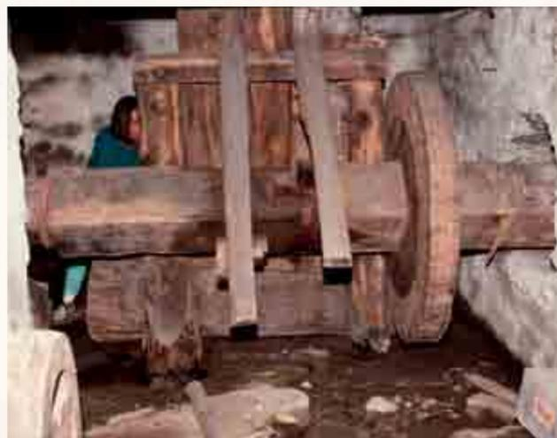
Dieses Foto zeigt die Walke mit Antriebsrad und Hämmern. Durch den Walkprozess schrumpften die Stoffe in der Länge und Breite um gut 10 Prozent und wurden somit dichter.
